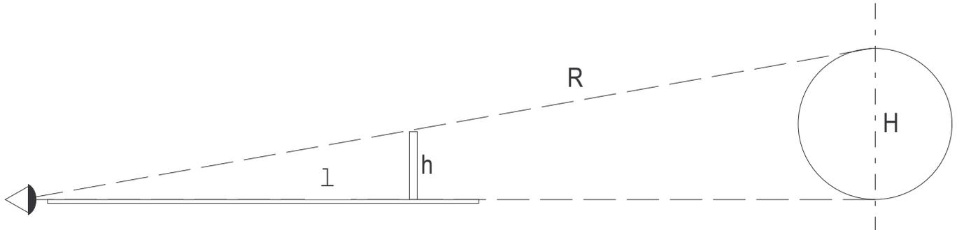
**Schéma de la méthode de mesure :  $h$  diamètre du disque utilisé.  $H$  diamètre de la lune.
