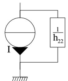
Figure 5 : Circuit équivalent à la sortie du miroir de courant.
