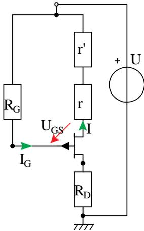
Figure 3 : Circuit de polarisation du PJFET.
