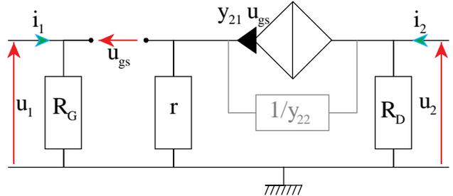
Figure 4 : Circuit équivalent au montage pour le régime permanent de petits signaux.  $1/y_{22}$  est négligeable ici.
