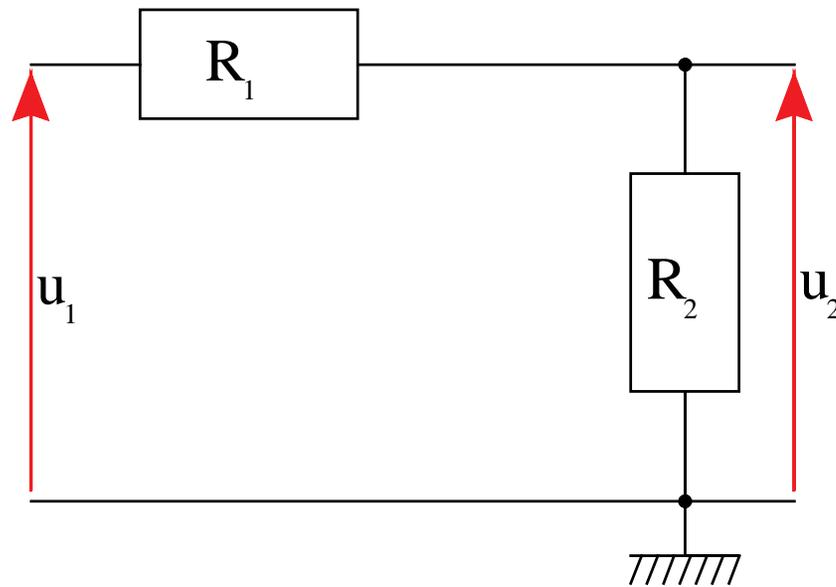
Le filtre est équivalent à un pont diviseur  $R_1, R_2$ , soit donc,
