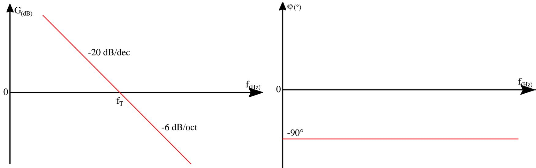
**Instable : Gain infini à fréquence nulle**
