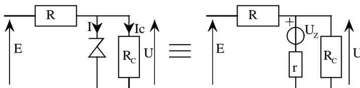
Ici  $U \sim U_Z = \text{cte}$  aux bornes de la charge  $R_C$ .
