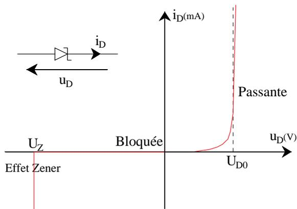
La diode Zener est une diode dont les zones P et N sont fortement dopées. Quand cette diode est polarisée en inverse, des porteurs de charge voisins de la jonction peuvent traverser la zone de déplétion par effet tunnel.
