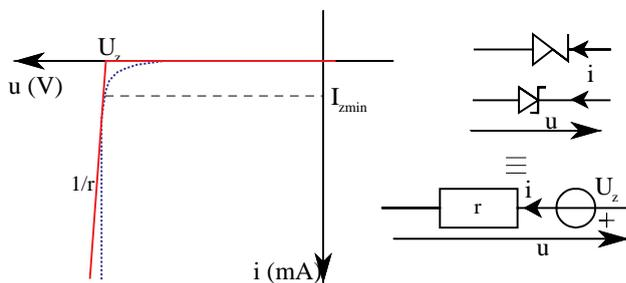
Le courant inverse est pratiquement indépendant de la tension  $u \sim U_Z$ . La résistance dynamique  $r = du/di$  est très faible. La convention des signes aux bornes d'une zener est inverse de celle d'une diode.
